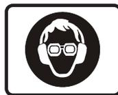
*Ao operar a máquina, use equipamento de proteção individual (EPI). A exposição prolongada ao ruído, sem proteção, pode provocar perda auditiva.*
